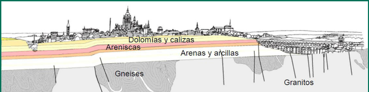
Esquema que ilustra el basamento del casco histórico de Segovia. Díez Herrero, A. y Vegas Salamanca, J. (2011)
